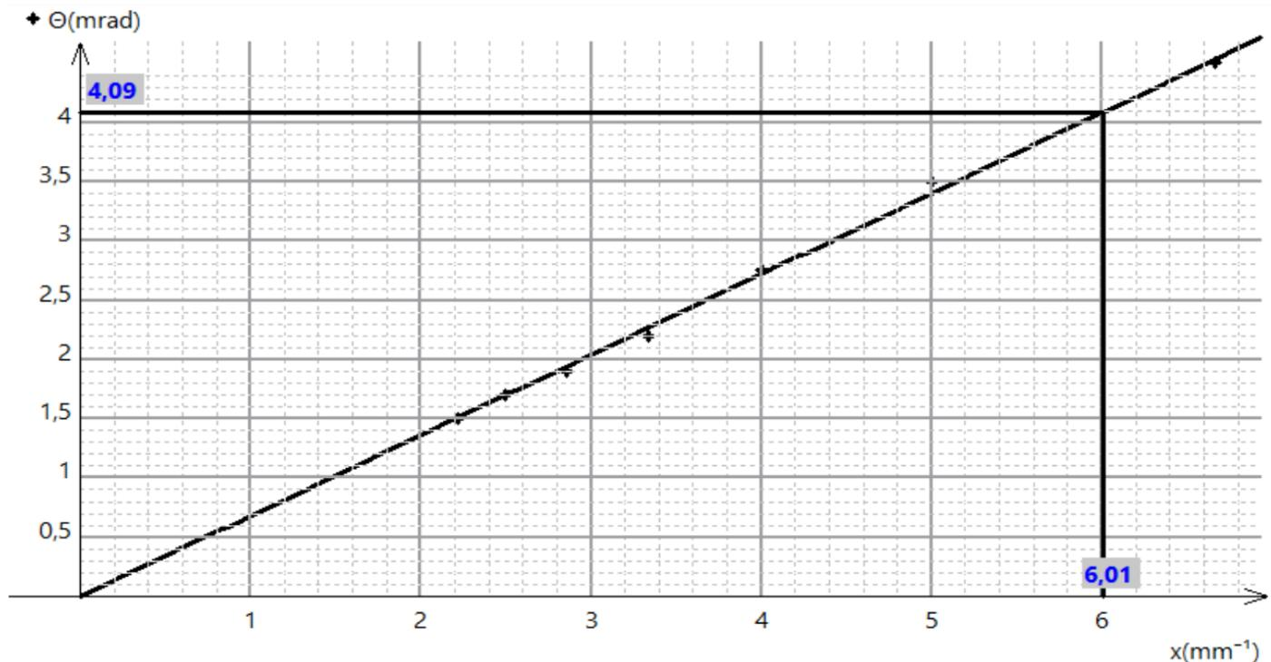
2.4.  $p = \frac{\text{variation des ordonnées}}{\text{variation des abscisses}} = \frac{\Delta\theta}{\Delta x} = \frac{4,1 \times 10^{-3} - 0}{6,0 \times 10^3 - 0}$  soit  $p = 6,8 \times 10^{-7}$  m
