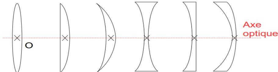
Les lentilles minces présentent un **axe de symétrie** appelé **axe optique** et un **centre** appelé **centre optique** noté O (situé sur l'axe).
