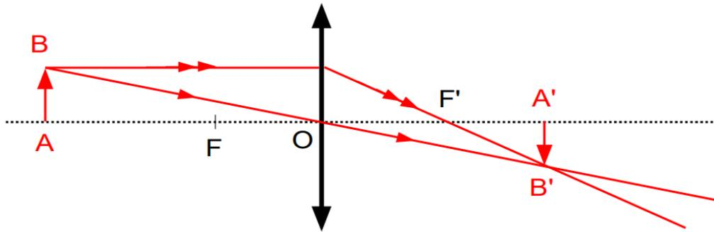
L'image A'B' de l'objet AB est au point de croisement des rayons émergents de la lentille. Cette image peut être captée sur un écran. A'B' est une image réelle.
