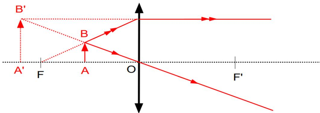
L'image A'B' de l'objet AB est obtenue par prolongation des rayons émergents de la lentille. On ne peut pas la capturer sur un écran.
