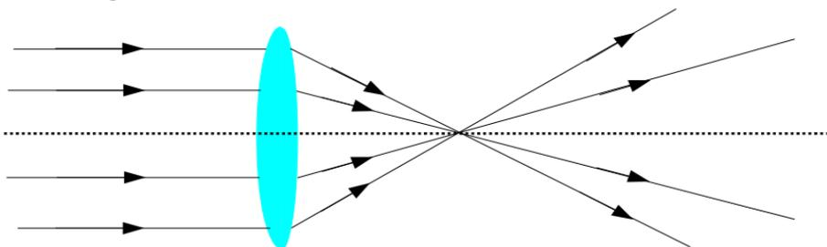
Des rayons parallèles à l'axe sortent de la lentille en **convergent** vers l'axe optique. Le point de convergence s'appelle le **foyer image** de la lentille, noté F'. La distance  $OF' = f$  est la **distance focale** de la lentille (mesurée en m).
