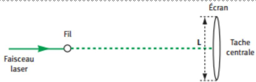
**Figure 2** : vue de dessus : le fil est perpendiculaire au plan de la figure
