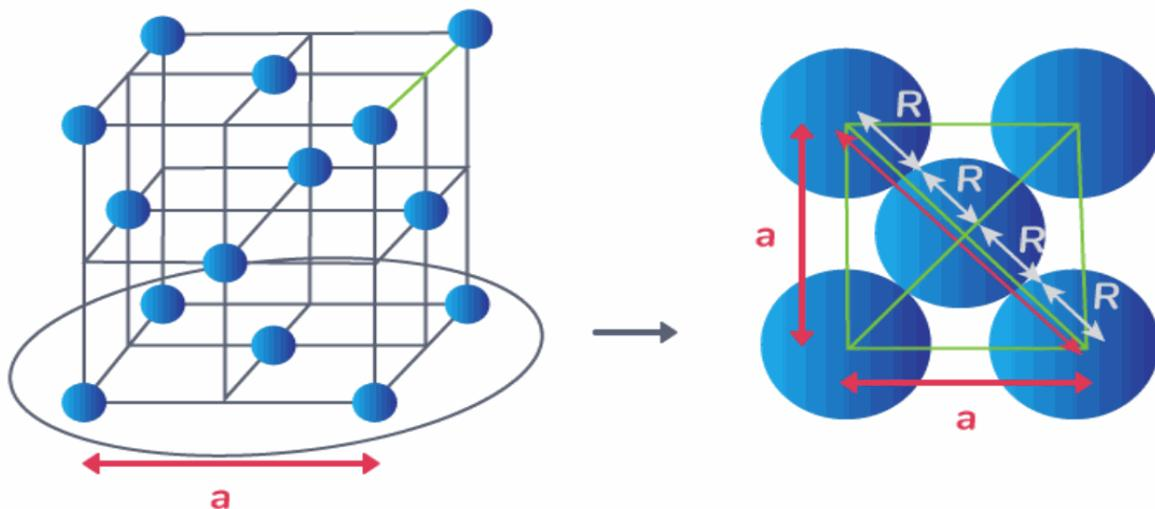
Taille des sphères et longueur d'un réseau cubique à faces centrées
