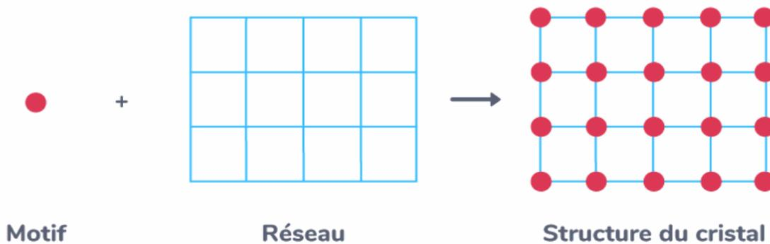
On représente la façon dont s'organise un cristal par une forme géométrique en trois dimensions. Le motif élémentaire peut y être placé à différents endroits (au sommet, au centre des bases, sur les faces, etc...) cela constitue la maille.
