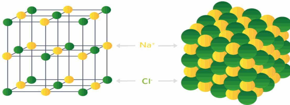
Réseau cubique à faces centrées d'un cristal de chlorure de sodium
