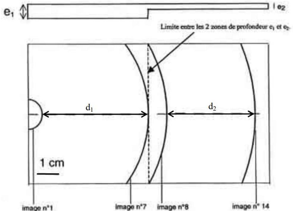
**Pour la zone de profondeur  $e_1$  :** Entre l'image n°1 et l'image n° 7, il s'est écoulé une durée  $\Delta t_1 = 6\tau$ .
