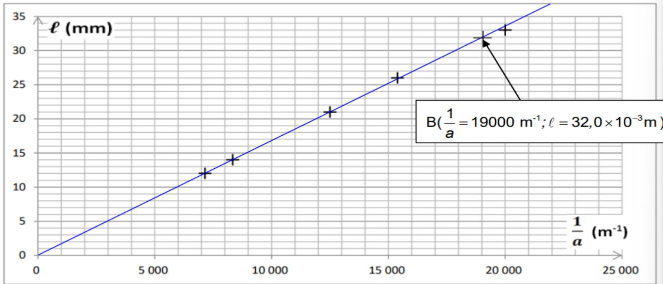
La mesure de la largeur de la tache centrale de diffraction a donné :  $\ell = 17,0 \text{ mm}$ . L'incertitude-type sur la mesure réalisée est :  $u(\ell) = 0,5 \text{ mm}$ . La modélisation du nuage de points  $\ell = f\left(\frac{1}{a}\right)$  par un tableur-grapheur a fourni la valeur de la constante  $k$  avec son incertitude-type associée :  $k = 1,67 \times 10^{-6} \text{ m}^2$  et  $u(k) = 0,04 \times 10^{-6} \text{ m}^2$ .
