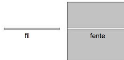
On réalise au laboratoire une expérience afin d'illustrer le principe de la mesure de la taille d'un objet de faible dimension en mesurant le diamètre d'un fil par diffraction.
