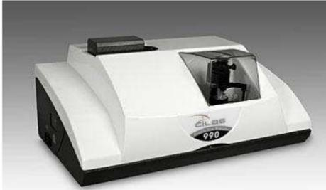
L'appareil ci-contre permet de mesurer la taille de particules allant de 40 nm à 2500  $\mu\text{m}$  tout en occupant un encombrement extrêmement réduit.
